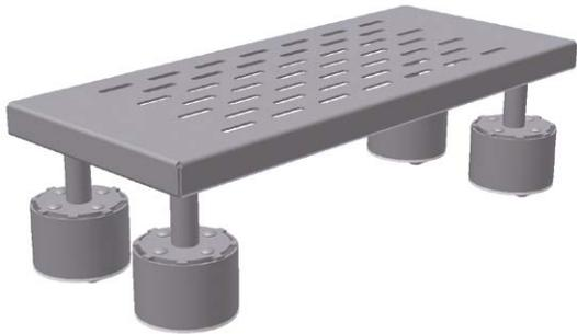
Trittleiter aus Edelstahl mit abdeckbaren Lenkrollen. Wird Gewicht auf die erste Stufe aufgebracht, verschwinden die Rollen und die Abdeckungen mit Reinraum-geeignetem Nylon-Schutz liegen fest am Boden an, wodurch eine sichere Benutzung der Leiter gewährleistet ist.
